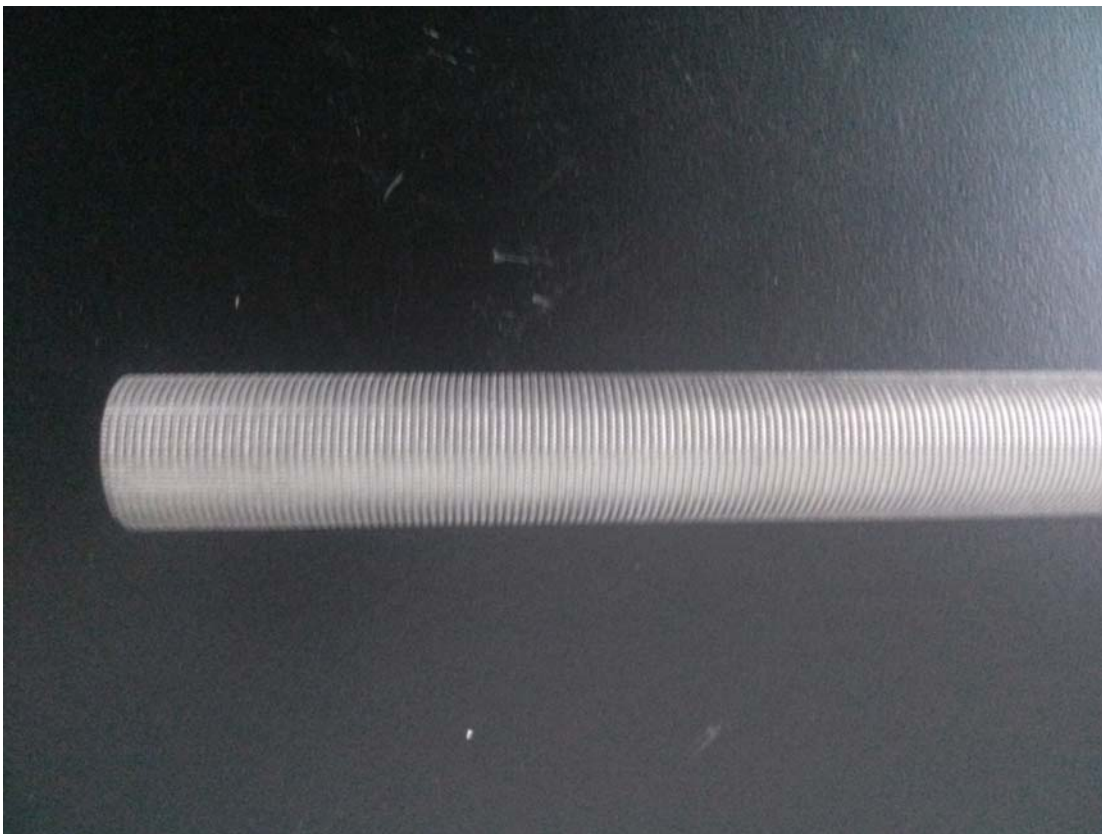
图2 耐腐蚀高效率换热管
