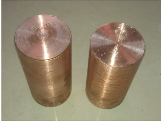
大尺寸铜铬合金铸锭（直径90mm，高度220mm）
