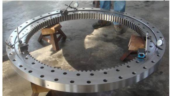
图 4 产学研成果四：舰船推进器用大型转盘轴承
